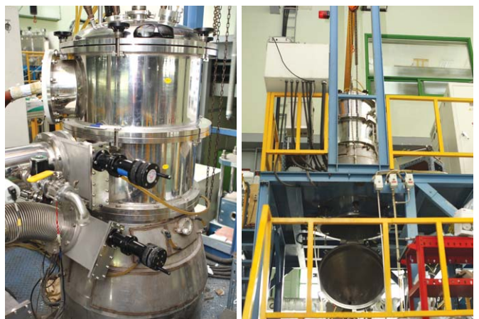
▲ 액상의 초고강도 철합금 소재에 고압의 가스를 불어넣어 분말로 제조하는 실험장비(우측)와 이 장비의 상세 모습(좌측)
