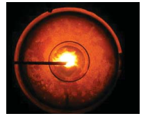
▼ 중유 가스화 연소기의 성능 실험 중 화염 정면을 촬영한 모습
