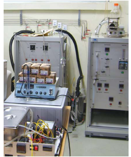
▲ 씨엔엘에너지 직원이 연료전지 성능평가장비를 조립하고 있다. ▲ 추천호 부장과 직원이 연료전지의 주변장치에 대해 상의하고 있다. ▲ 씨엔엘에너지가 공급하고 있는 연료전지 성능평가장비
