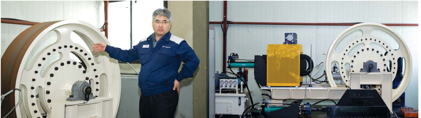
▲ 이범주 상무이사가 항공기 브레이크의 제동성과 내구성을 측정할 수 있는 '항공기용 브레이크 다이내모미터'에 대해 설명하고 있다.
