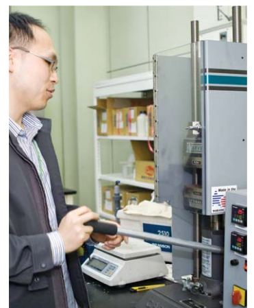
▲ 김현중 박사가 프레스로 백금 촉매를 전해질막에 코팅하는 과정에 대해 설명하고 있다.
