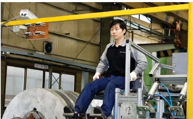
▲ 다윈프릭션이 한국형 기동헬기 수리온의 제동장치를 개발하기 위해 회사에 설치한 통합 시험 장비
