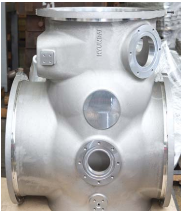
▲ 대신금속과 생기원이 공동개발한 GIS Tank
