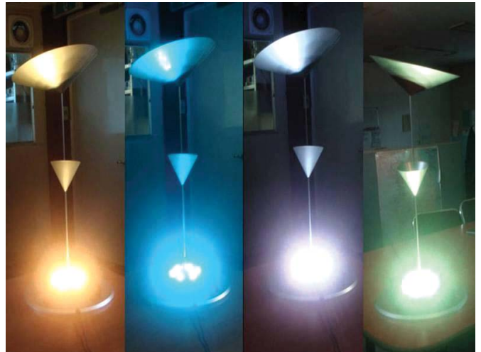
▲ 연속조명 구현 중인 LED 스텐드 (RGGB를 이용한 고감도 색상 연속 구현의 순간 이미지 모음)
