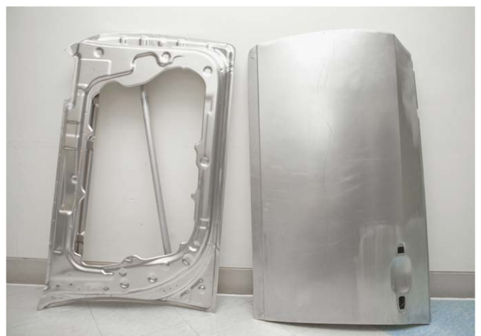
▲ 알루미늄 용접기술로 제작된 자동차 도어 시제품.
