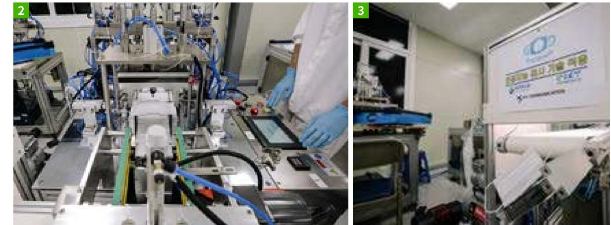
마스크 공정에 도입된 영상패턴분류기술은 실시간 분류가 가능한 객체탐지(Object Detection) 딥러닝 모델을 기반으로 구현해냈다. 먼저 1차 제조된 마스크가 컨베이어벨트를 통해 별도 제작된 영상수집 장비로 이동한다. 장비 내 RGB 영상 수집·처리 모듈이 마스크를 촬영해 이어링의 위치를 추정한다. 이를 기반으로 객체 탐지 딥러닝 알고리즘이 이어링 접합 여부를 실시간 식별하고 만약 불량이 발생한 경우 분류 모듈을 통해 걸러낸다. 시범 테스트 결과, 마스크 검수 정확도는 약 99.7%에 달했고 마스크 1개당 위치 탐지 및 불량품 분류까지 걸리는 시간이 최대 1/15초에 불과해 속도도 빨랐다. 연구팀은 지난 9월 초 KS커뮤니케이션 공장에 모듈을 설치해 본격적인 가동을 시작했다.
