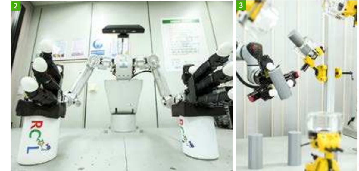
이어 배 수석연구원은 “쉽게 말하면 일종의 ‘지능맵’이라고 보면 된다. 넣을 물체를 기울인 상태에서 홀로 가져오다가 홀에 걸리면 정지한다. 그러면 ‘다 왔구나, 이 다음에 뭘 하지’를 스스로 판단하는 것이다. 그리고 기울인 상태에서 위에 있는 손가락을 아래 방향으로 누르면 합력이 생겨 구멍 안으로 물체가 빨려 들어가 조립된다.”고 말했다. 개발된 로봇손가락은 현재 오차 0.1mm 수준으로 조립 작업을 수행할 수 있으며, 약 3초 내외의 시간이 소요된다.
