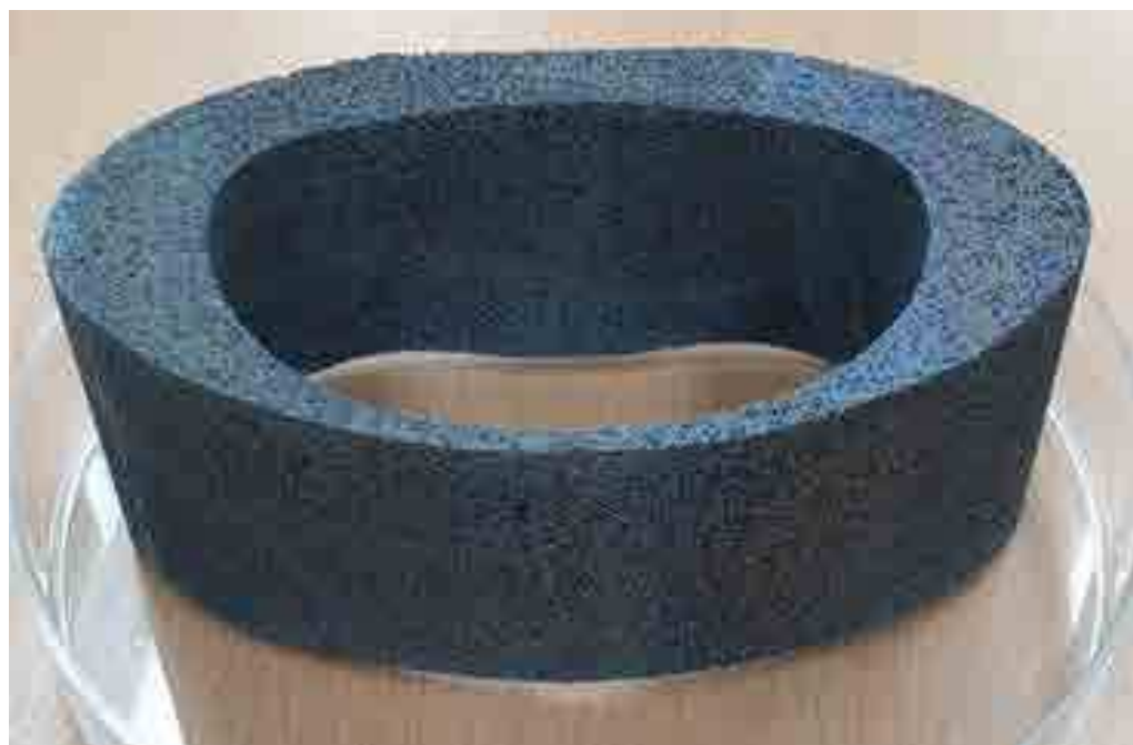
● 금형몰드를 이용해 제작한 무류관절용 다공성 임플란트 시제품
