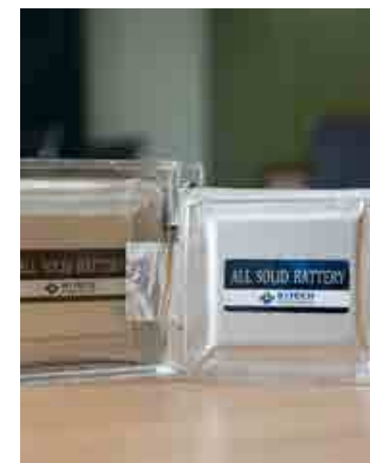
단위셀을 직렬로 10개 연결하여 제작한 바이폴라 구조의 37V, 8Wh 급 셀스택
