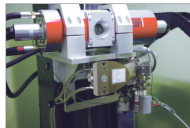
▲ X-ray 발생 장치 X-ray 튜브
