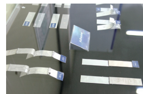
▲ 금속 소재를 다양한 방법으로 용접, 접합한 시험 샘플
