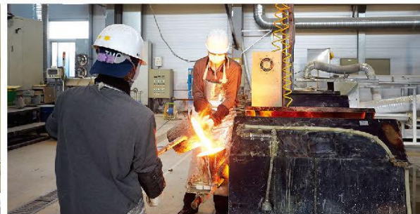
▲ (위) 티엠시의 원심주조 기술로 뜨거운 용탕을 회전체에 붓고 있는 작업 현장 모습 ◀ (왼쪽부터) 융복합부품 · 농기계그룹 김대업 그룹장, (위) 티엠시 김기열 부사장, 김제뿌리기술지원센터 김재황 센터장
