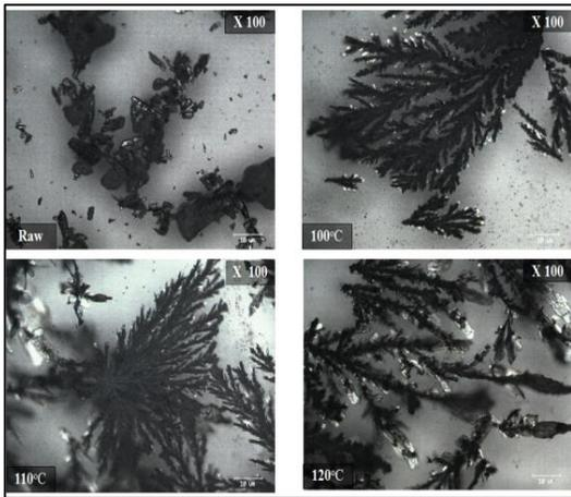
정제과정 전후의 NPB(N,N'-Di-[(1-naphthyl)-N,N'-diphenyl]-1,1'-biphenyl)-4,4'-diamine) 소재의 결정상 광학현미경 사진
