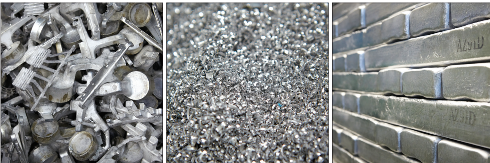
▲ 제품 성형 후 발생한 스크랩(좌), 가공 후 발생한 칩(중), 재활용을 거친 마그네슘 원재료 잉곳(우)
