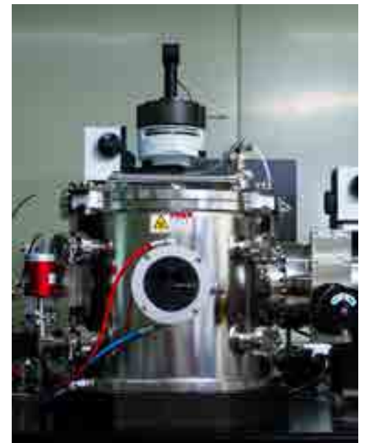
개발된 화학증착소재 실시간 증착막 측정 시스템. 가운데 큰 원통 모양의 화학기상증착 장비에 오른쪽에 위치한 라만 광원 기반의 실시간 측정·분석 장치가 결합되어 있다.
