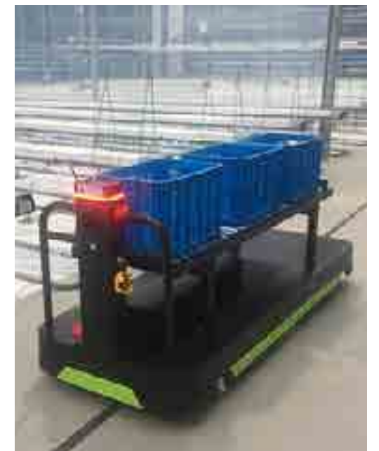
스마트폰으로 온실용 작업관리 시스템을 시연하는 모습 (왼쪽)과 작업을 더욱 수월하게 해주는 무인 이송로봇
