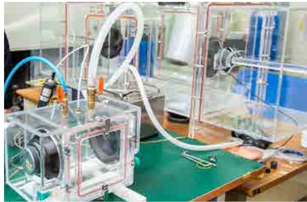
양쪽 스피커에서 음파를 쏘면 미세먼지가 음파에 의해 움직인다. 다른 미세먼지와 부딪히며 뭉쳐진다.
