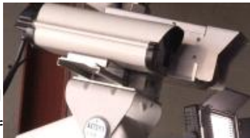
그림 2. 영상감지 및 원격조종 화재진압장치
