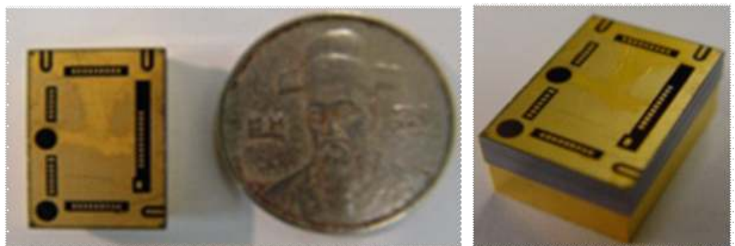
그림 2. TSV를 이용한 타일형 송수신모듈
