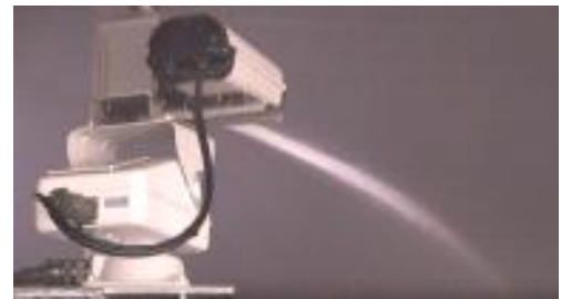
그림 2. 영상감지 및 원격조종 화재진압장치
